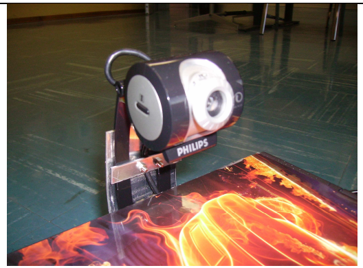
Figura 2: dettaglio del sistema visivo costituito da una webcam della Philips
